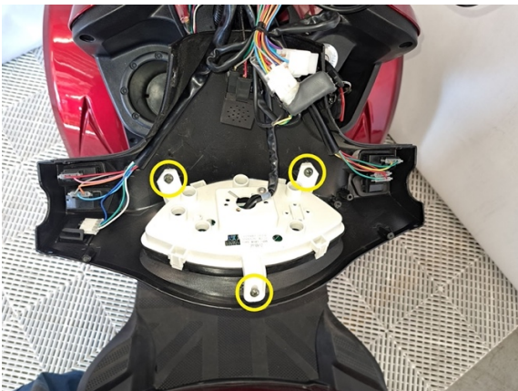
Irrota mittariston kolme kiinnitysruuvia. (ristipäämeisseli ph2).
