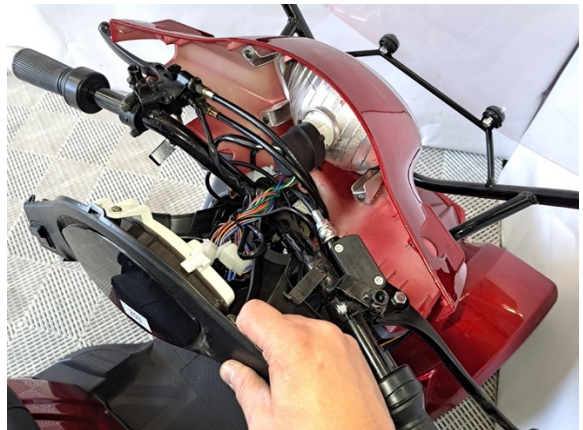
Irrota mittaristo kehyksineen etumaskista
